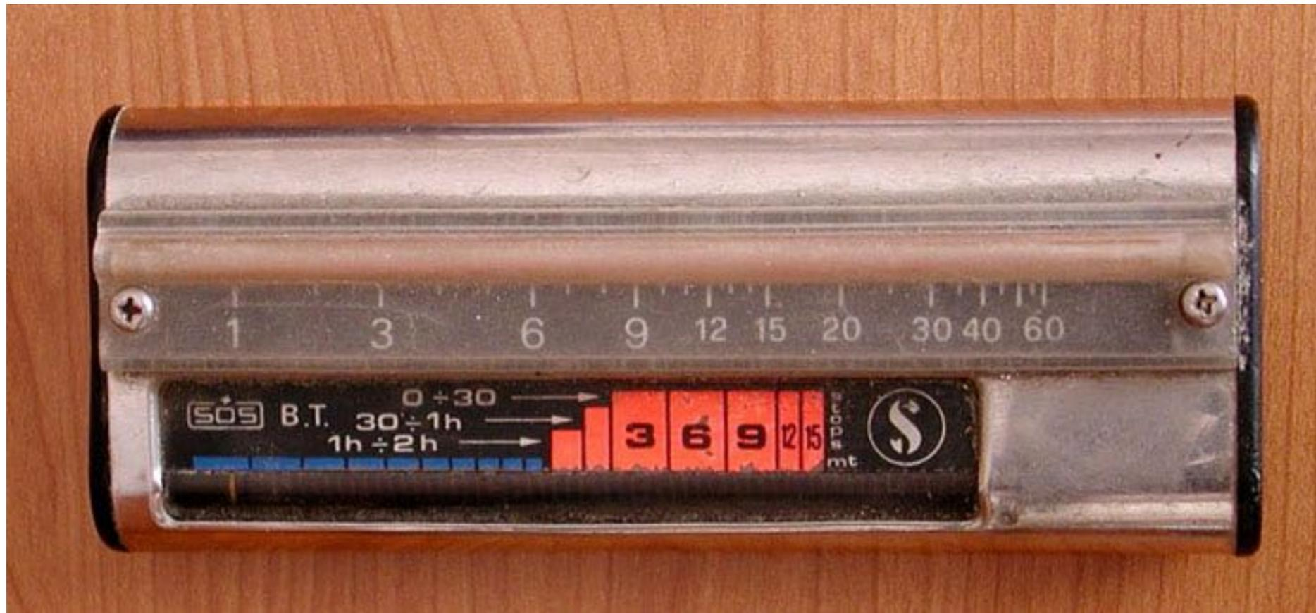
Appareil entièrement mécanique. Il fonctionne sur le principe du tube de Bourdon.
