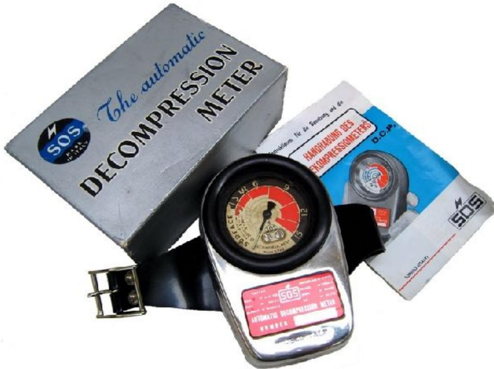
L'appareil se voulait une aide à la décompression en reproduisant au mieux les phénomènes de saturation/désaturation des tissus du corps humain. Composé d'un tube de Bourdon, le mécanisme comprimait à la descente un ballon de gaz, lequel gaz se diffusait à travers une membrane de céramique aux propriétés « saturantes » proches d'un tissu humain (enfin censé l'être). Et inversement à la remontée.
